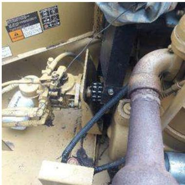
Foto 16 - Partes móveis e quentes sem proteção adequada. Falta de sinalização do equipamento
